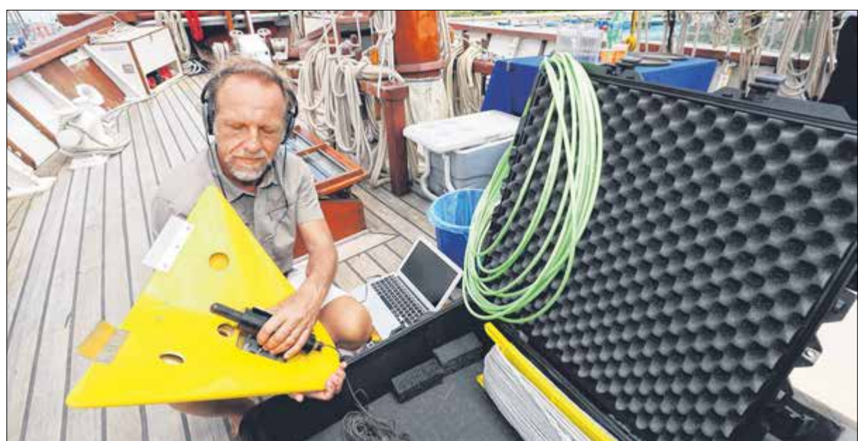
生物学家安德烈运用手上的“V-Wing”器材在帆船船尾拖放声音传感器，一路记录海底的声音。（陈来福摄）
